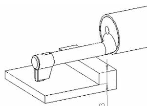
图 5.5.4-3 TS130 深槽传感器测台阶
