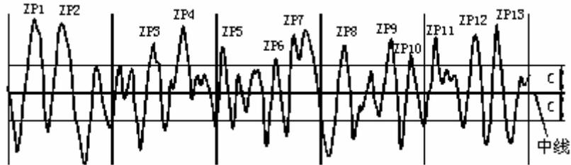
图中的  $C$  为两条与中线平行的直线到中线的距离。 $C$  值的选择有两种方式，一种是绝对值方式，即  $C$  值实际距离的绝对值；另一种是相对百分数方式选定。首先确定评定所需要的  $C$  值，然后，计算  $RP_c$  峰计数值，一个高于  $C$  值的峰与一个相邻的低于  $C$  值的谷组成  $RP_c$  峰计数值的一个数。 $RP_c$  是在评定长度上计算评定的，公式如下：
