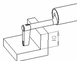
图 5.5.5-3 TS131 深槽传感器测台阶
