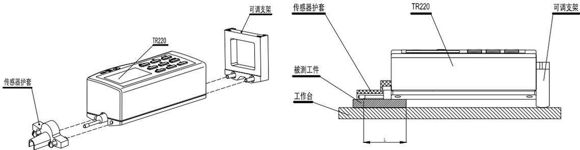
图 5.1-1 可调支架和传感器护套的连接
