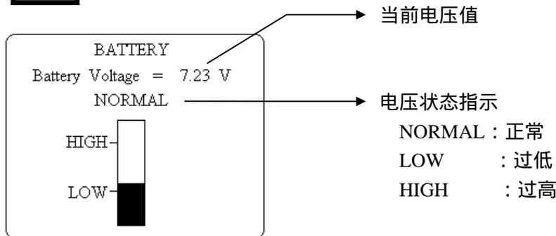
屏幕下方的条形图表示当前的电压状况，而不是电池容量。当黑条高度在“LOW”与“HIGH”之间时，表示电压正常。“LOW”为电压偏低提示线，“HIGH”为电压过高提示线。
