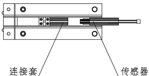
安装时，将传感器插入驱动器主体下的传感器连接套中，如图 2.5 所示，再轻轻推入即可。拆卸时，将传感器从与连接套相接部轻轻推出。应注意不要碰及触针，以免造成损坏。
