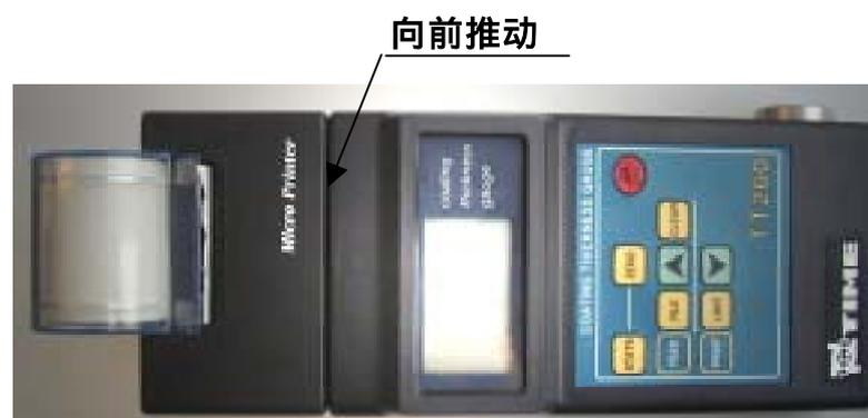
图 5-3 装、卸下打印头
