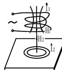
图 1-2 涡流法基本工作原理
